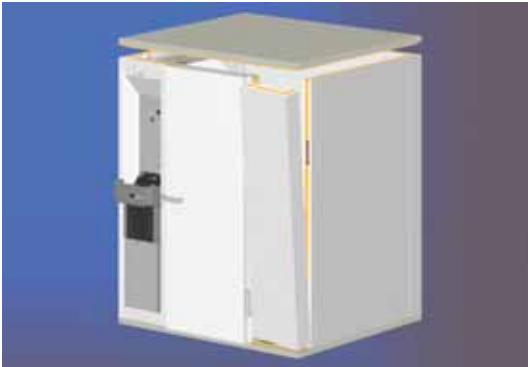
Bild 8. Der Aufbau der Dach- und Eckelemente
