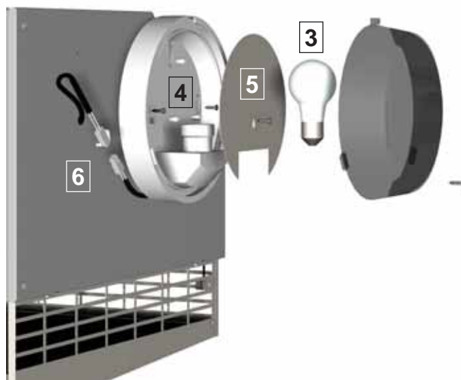
Photo 11b. Montage de l'éclairage intérieur
