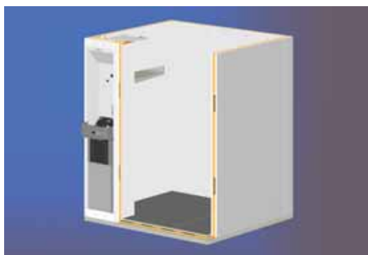
Fig. 7. Montage af vægpaneler
