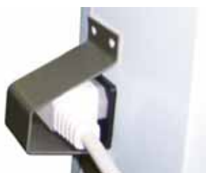
Kuva 10. Karmivastuksen kaapeli ja suojus
