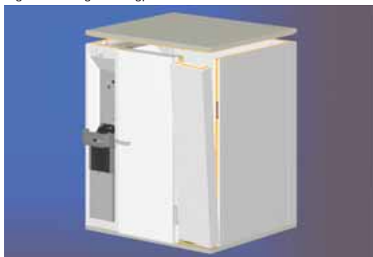
Fig. 8. Montage af hjørne-, dør- og loftspanel
