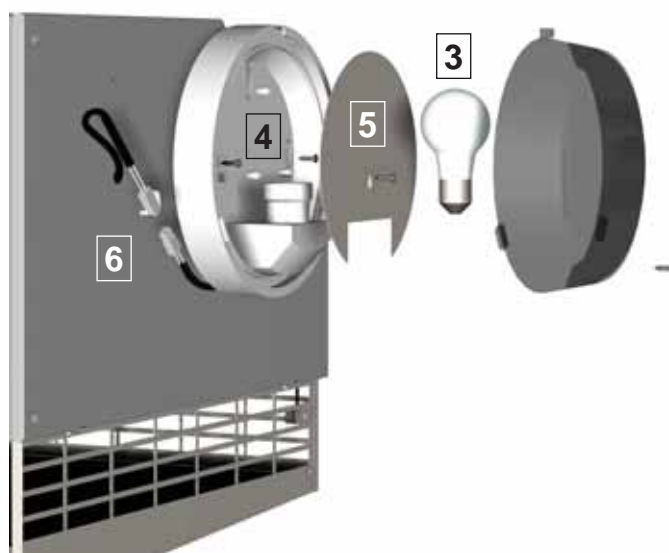
Abb. 11b. Montage der Innenbeleuchtung
