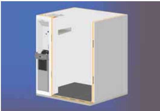
Fig. 7. Montage af vægpaneler
