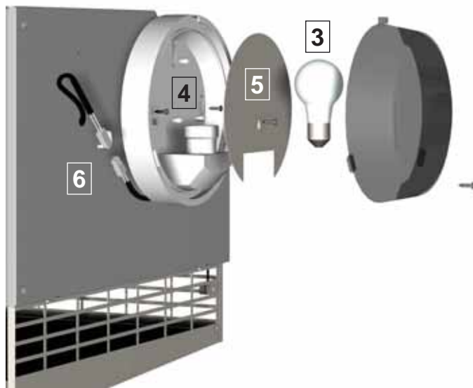
Photo 11b. Montage de l'éclairage intérieur
