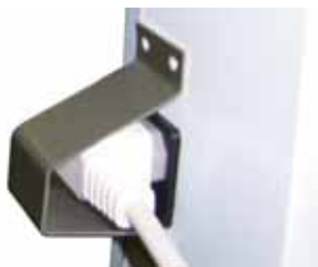
Kuva 10. Karmivastuksen kaapeli ja suojus
