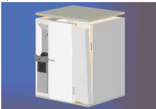
zdj. 8 montaż elementów narożnych i dachu
