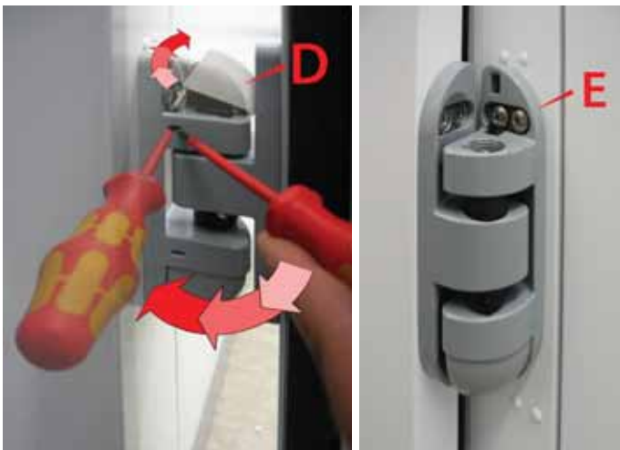
Tekening serie 13: Montage van de scharnieren
