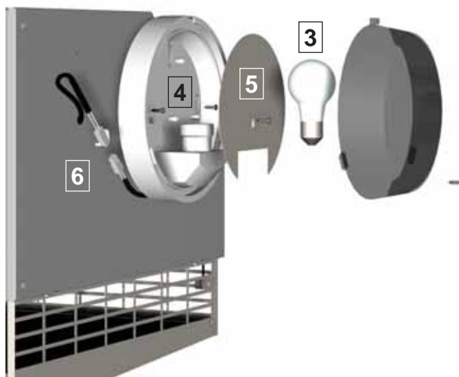
Fig. 11b. Montering av lysarmaturen
