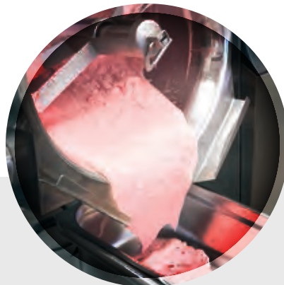
Kallistuskorkeus 600 mm. Pata on ergonominen ja helppo tyhjentää, kun monitoimivaunu mahtuu nokan alle.
