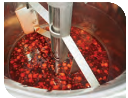
Vahva, huoltovapaa, kahteen suuntaan pyörivä monitoimisekoitin kaikkeen sekoitukseen, myös vispaus. Saatavana myös Heavy duty -sekoitin vielä raskaampaan käyttöön.
