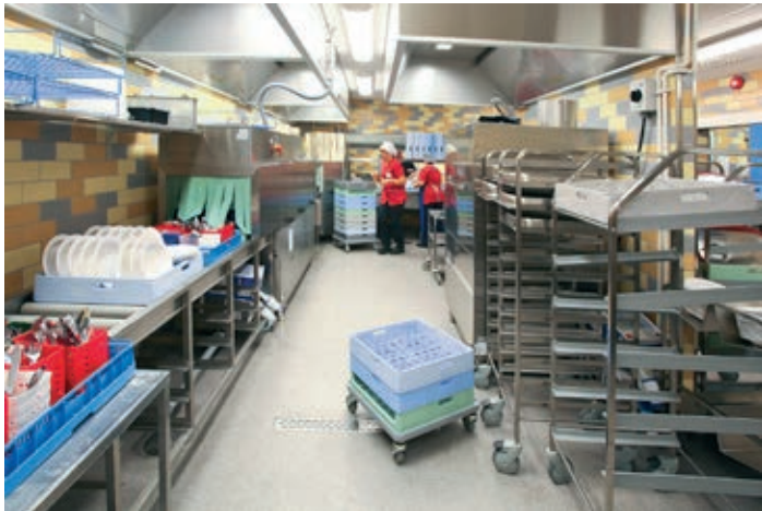
Tuotantokeittiön pesuosastolla on käytössä ympäristöystävällinen Metoksen ICS+ -pesuteknologia. Patapesukoneena on Metos Master GR 300 -raepesukone.
