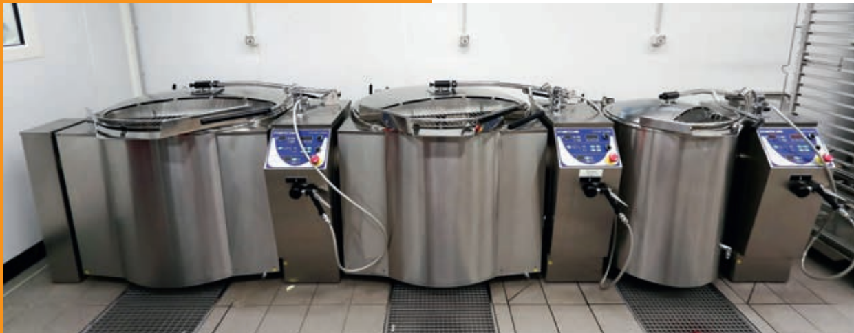
Les marmites avec brasseur de la gamme Culino Combi ont des capacités utiles allant de 40 à 400 litres
