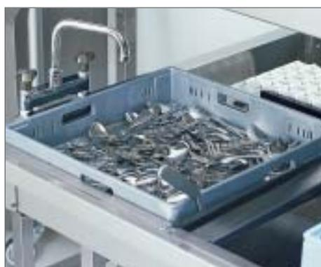
Le bac de trempage couverts est une option qui améliore considérablement le résultat de lavage des couverts. Le trempage aide à retirer les salissures, particulièrement si les couverts sont accumulés avant d'être lavés. Grâce à la poignée de levage, il est facile de sortir le panier de l'eau.
