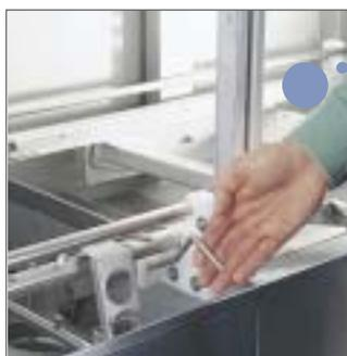
Toutes les cuves se vident par la manipulation d'un seul levier. Toutes les bondes et la surverse se ferment automatiquement quand la porte de la section rinçage est fermée.
