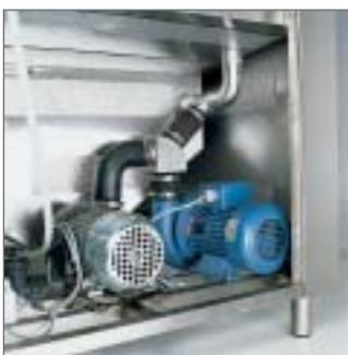
Le système de centrifugation à double pompes réduit la consommation d'eau, de granules, d'électricité et de produits lessiviels.
