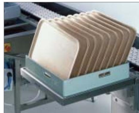
Avec la table de chargement pour plateaux, il est possible de charger des paniers de plateaux entre deux. Cette table peut être repliée lorsqu'elle n'est pas utilisée.
