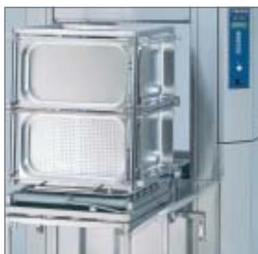
Du côté propre la cage glisse sur le chariot de sortie.
