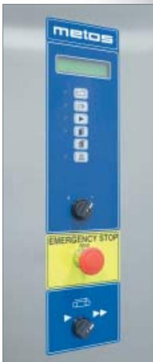
Les machines à convoyeur Metos WDB disposent de tableau de commandes à affichage texte en standard à partir de la WD-B 76 E.
