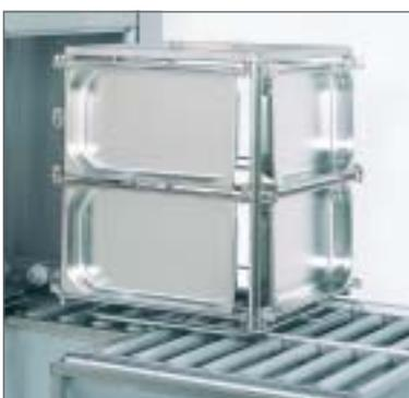
La cage glisse facilement de la table de chargement à l'intérieur de la machine.
