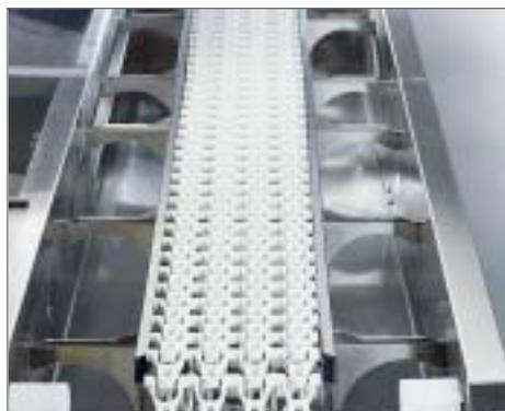
Les systèmes de retour et de tri automatiques et HI-LO sont équipés d'un convoyeur à chaîne hygiénique. Grâce à la conception de cette chaîne ouverte, le nettoyage est possible sans soulever ou retirer le tapis convoyeur.
