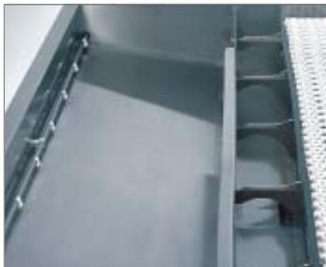
Lorsque les grilles support paniers sont enlevées, la cuve est libre et peut être facilement nettoyée. Grâce à la pente de la cuve, les résidus s'accumulent dans le fond de la cuve.
