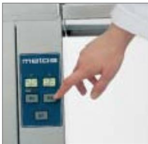
Le panneau de commandes affiche le programme sélectionné, la durée restante du cycle de lavage, la température de rinçage et de lavage et les anomalies possibles. Ce lave-vaisselle WD-6E possède 3 programmes de lavage (la durée et la température de lavage et de rinçage, peuvent être programmées). Cet appareil possède aussi un programme d'auto-nettoyage et une fonction de pause. L'affichage permet aussi de faire apparaître le nombre de casiers lavés par jour et depuis l'installation.
