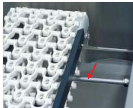
L'hygiène de la chaîne est garantie par un système de rinçage. Cette fonction peut être par ouverture et fermeture manuelle (en standard) ou automatique.
