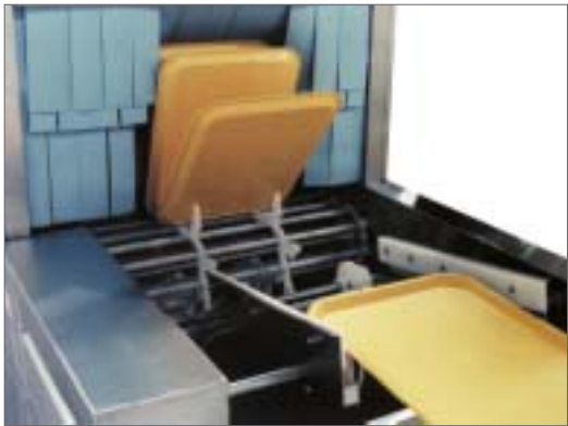
WD 40 BRE. De dienbladen worden in de machine gebracht d.m.v. een dienbladenband.
