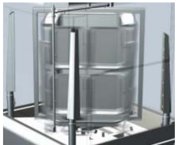
Het roteren van de inzetmodule versnelt het droog- en reinigingsproces.
