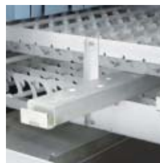
Wasarmen en filters zijn gemakkelijk bereikbaar en demonteerbaar.
