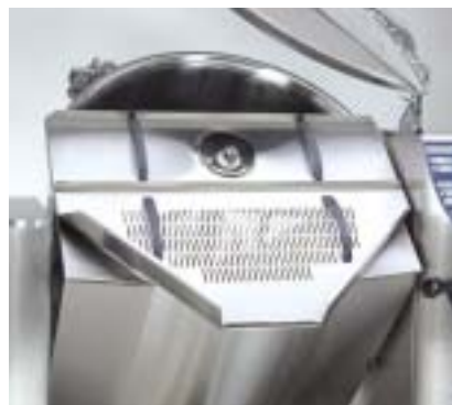
La trémie d'une marmite 300 l. est extensible en partie supérieure ( option )
