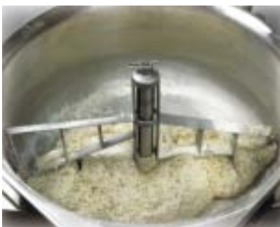
Proveno mélange une pâte en quelques minutes et la fait pousser dans la même marmite. ( programme de brassage n°6 ) et régulation de température TempGuard.
